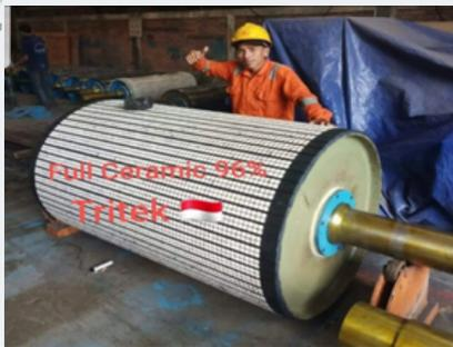
Dengan struktur yang kuat, memiliki ratusan keping keramik yang mengandung alumina 92%, full ceramic lagging tahan abrasi, anti slip dan efektif membuang kotoran (Pasir), lumpur dan air di permukaan belt.
